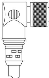
图 11 M12\*1 连接方式的电缆配件
