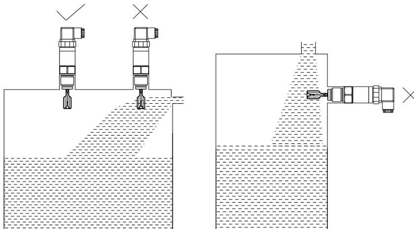
图 3 避免入料口的安装示意图
